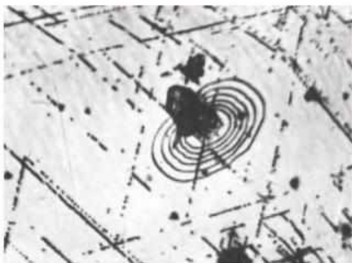
Рис. 1. Дислокационные петли у границ зерен и крупных включений в сплаве типа нимоник 80А, видимые в оптический микроскоп – источник Франка-Рида.
