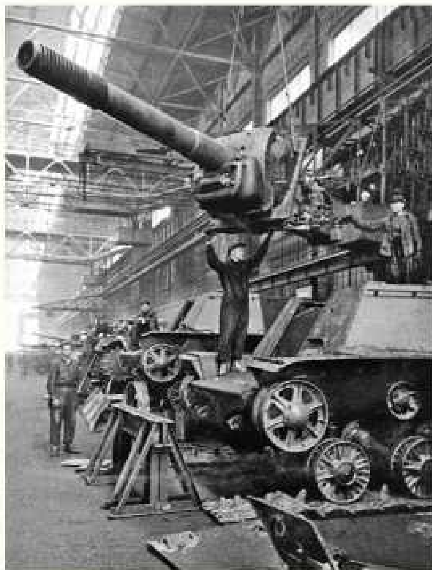
Сборка СУ-152: монтаж гаубицы-пушки МЛ-20С. Челябинский Кировский завод, 1943 год
