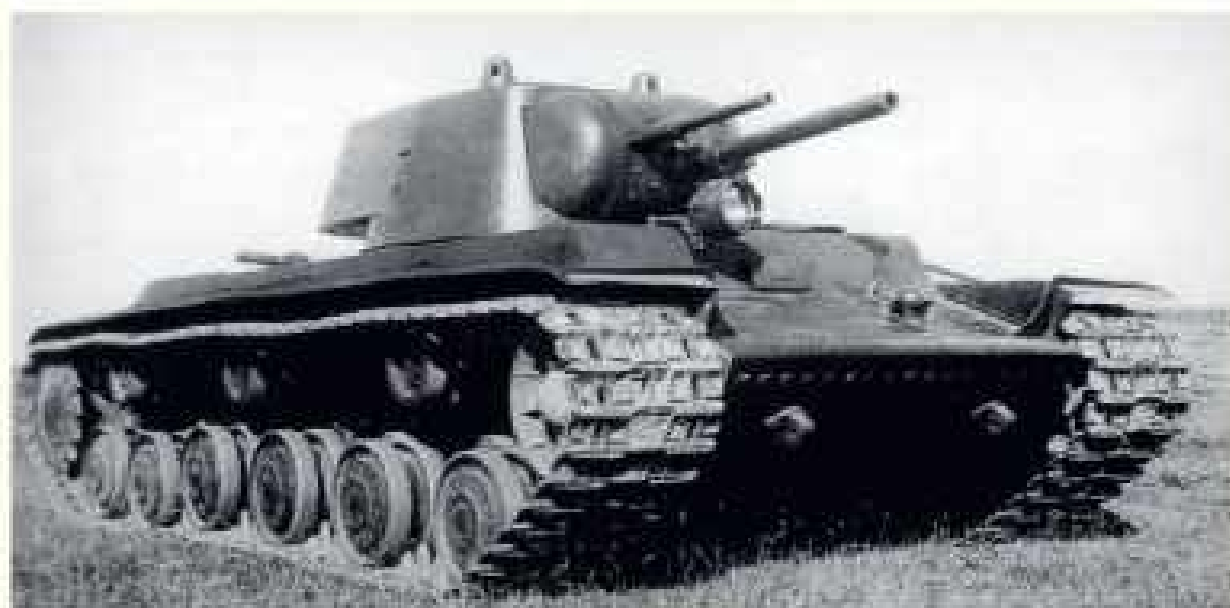
Первый опытный образец танка КВ с двумя орудиями в башне. Сентябрь 1939 года
