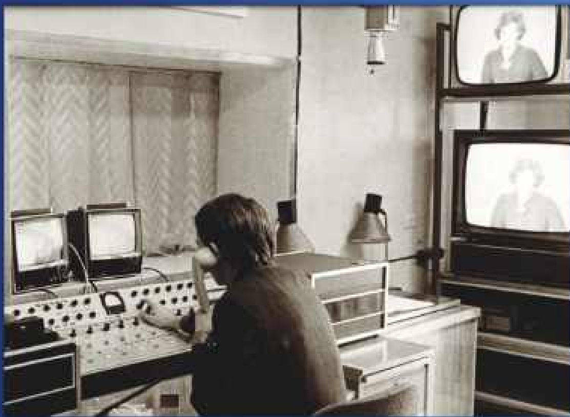
Центральный пульт управления учебной телевизионной системы
