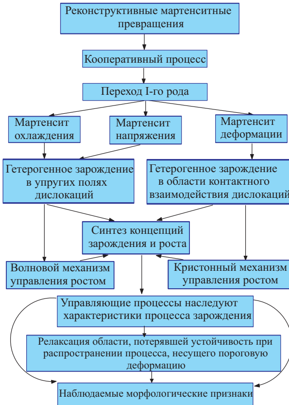
Рис. 1. Узловые моменты описания мартенситной реакции в моно- и поликристаллических материалах с размерами зерен, превышающими критический размер D_c
