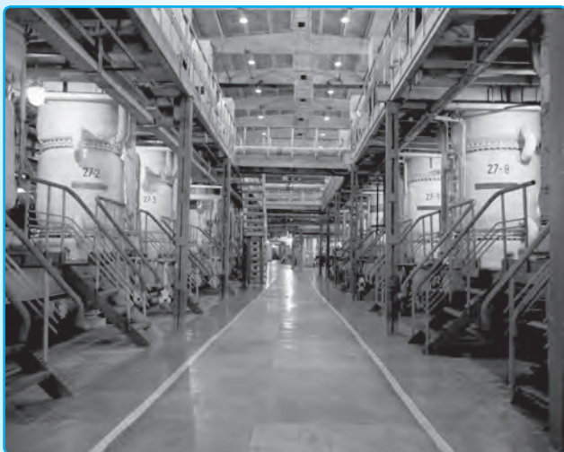
Химический завод. Десублиматоры. АЭХК, г. Ангарск, 2009 год.
