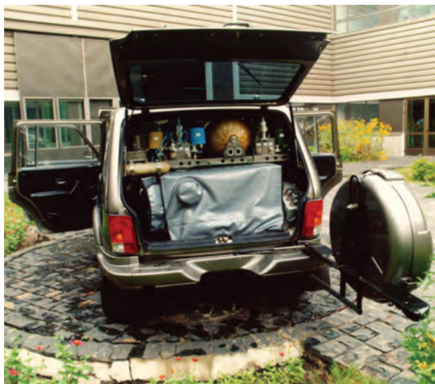
Рис. 5. Автомобиль на топливных элементах «Антэл-1»
