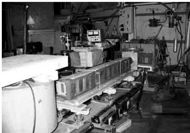
Нейтронный дифрактометр малоуглового рассеяния Д6
