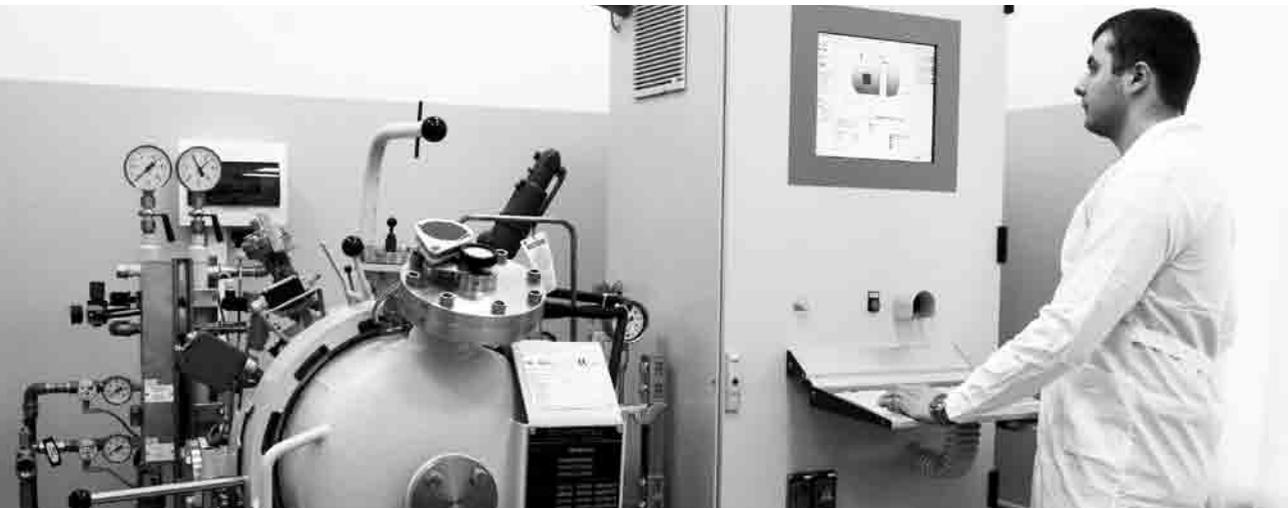
Индукционная печь PVA TERPLA, позволяет проводить плавку в вакууме и в защитной атмосфере (за пультом – научный сотрудник Д. Давыдов)
