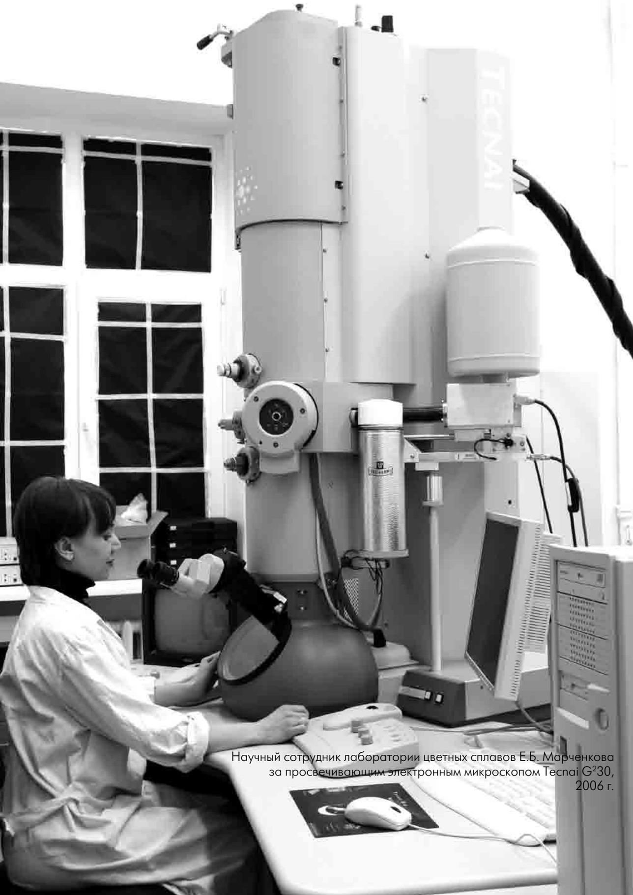
Научный сотрудник лаборатории цветных сплавов Е.Б. Марченкова за просвечивающим электронным микроскопом Теснаі G<sup>2</sup>30, 2006 г.
