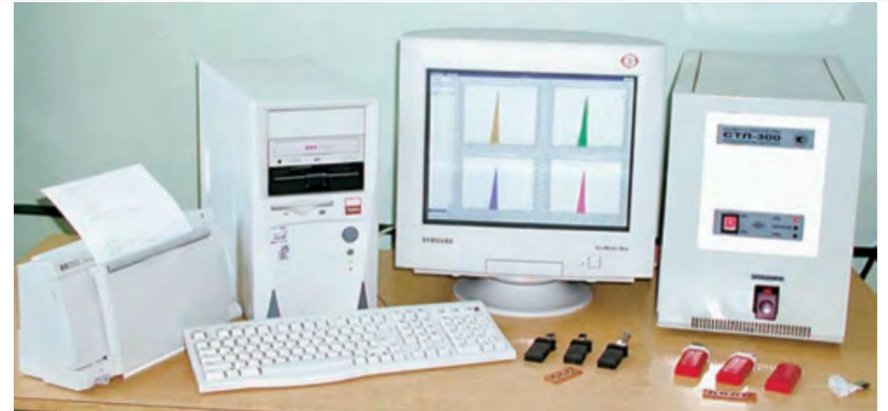
Автоматизированный комплекс индивидуального дозиметрического контроля АКДК-301. Комплекс предназначен для дозиметрического контроля в полях фотонного и смешанного гамма-нейтронного излучений. С момента начала выпуска комплексов на предприятия Федерального агентства по атомной энергии и других отраслей промышленности, а также в медицинские и научно-исследовательские учреждения поставлено более 60 единиц.
