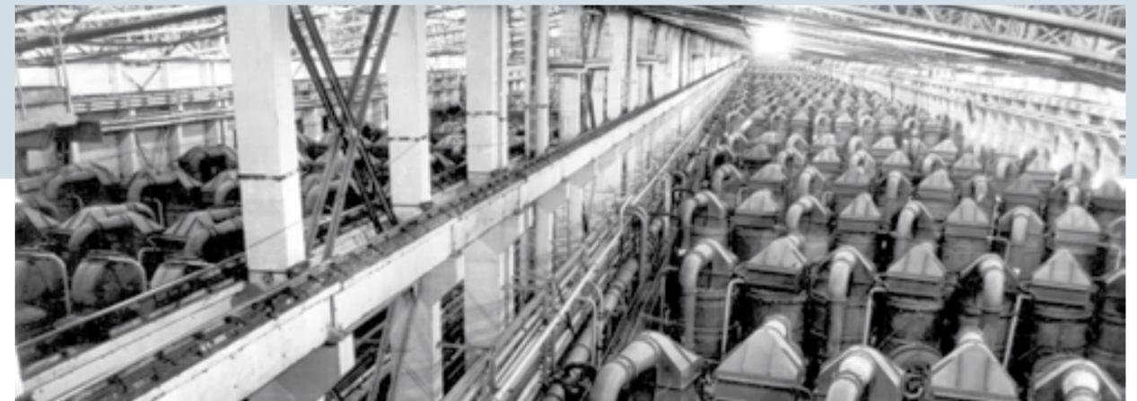
■ Закончен ввод в эксплуатацию электролизного (разделительного) завода. В четырех километровых корпусах располагалось более семи тысяч газодиффузионных машин, в состав которых входило более 14 тысяч мощных компрессоров, сжимающих в несколько раз гексафторид урана.
